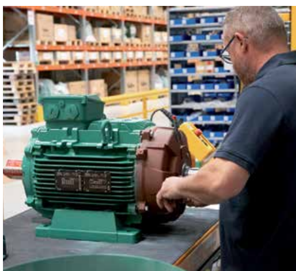
Assemblage des motoréducteurs
